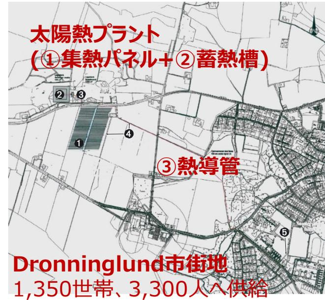
**蓄熱槽の概要**(6.2万㎡。90×90×D16m)夏季には頂部85℃、底部50℃程度の温水域が形成され、入出温度制御をしている
